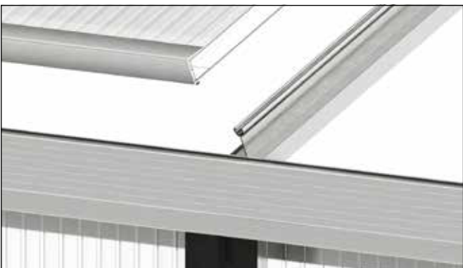
Setzen Sie die Dachplatte jeweils in die Dachflächen ein. Führen Sie diese dabei in das ausgeformte U des Firstes ein.
