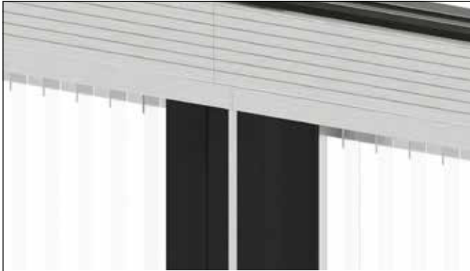
Drücken Sie das Gummiprofil fest gegen das Koppelprofil, bis es einrastet und sicher am Profil hält.
