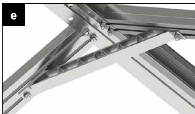
Setzen Sie die Versteifung auf und verschrauben Sie diese mit den Flanschmuttern M6 fest mit den Koppelprofilen.
